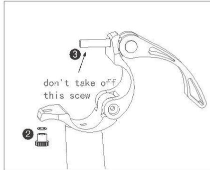
2. Mutter und Unterlegscheibe (**2**) beiseitelegen. Schraube **3 NICHT lösen.**
